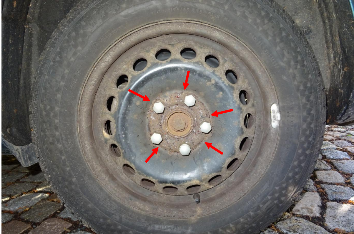
Foto 1 – deutliche Spuren von Rost ( rote Pfeile ) im inneren Bereich der Stahlfelge
