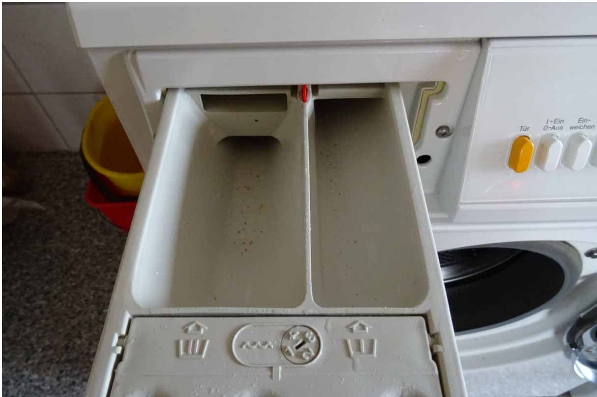
Foto 4 – Bestandteil der Waschmaschine, in dem eine Pilz- und Bakterienbildung entstehen kann
